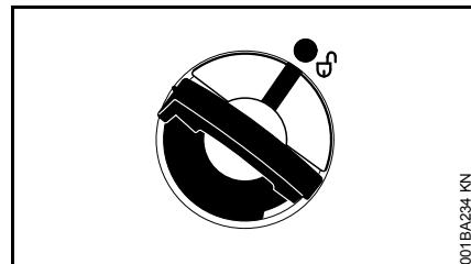
Маркировки на крышке бака и топливном баке должны друг с другом совпадать
