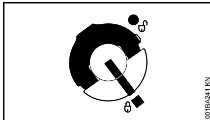
Крышка бака зафиксирована
