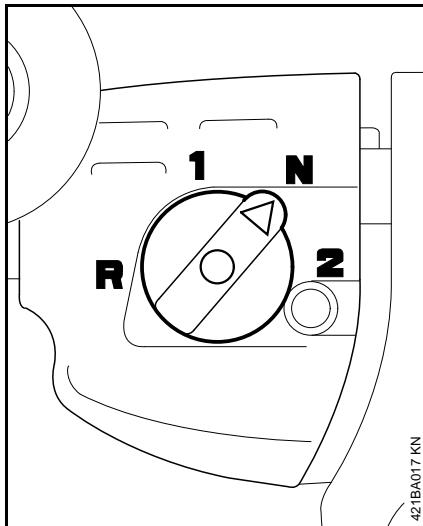
Буровая машина оснащена переключаемой передачей. В зависимости от применения и используемого бурового инструмента частота вращения может быть подобрана к требованиям.
