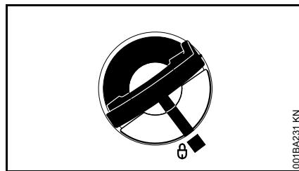
Тогда будут совпадать между собой маркировки на крышке бака и топливном баке
