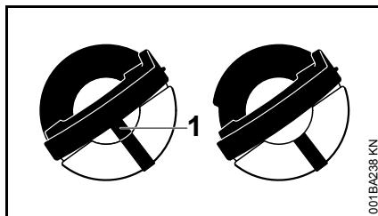
слева: Нижняя часть крышки бака перекручена – расположенная внутри маркировка (1) совпадает со внешней маркировкой
