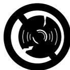
Чаше проверять абразивно-отрезной круг – абразивно-отрезной круг немедленно заменить, если обнаружены трещины, искривления или другие повреждения (например, перегрев) – при повреждении существует **опасность несчастного случая!**
