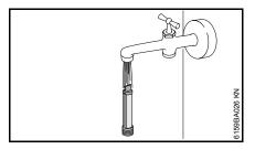
Промыть фильтр проточной водой
