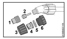
Отвинтить коническую насадку (1) с завихрителем (2) от струйной трубки
