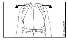
На случай аварийной ситуации: потренировать быстрое открывание замка на набедренном поясе (только SG 71), освобождение наплечных лямок и снимание агрегата со спины. При тренировке агрегат не бросать на землю, чтобы избежать повреждений.
