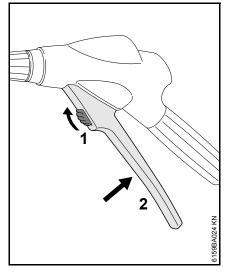
Сдвинуть предохранительный рычаг (1) наверх – рычаг (2) разблокируется и может быть выжат
