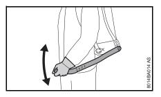
Медленно и плавно привести рычаг в действие, не нажимая на рычаг пистолета – несколькими протяжками создать давление
