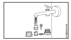
Промыть детали под проточной водой и снова собрать
