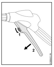
■ Предохранительный рычаг (1) сдвинуть вниз – рычаг (2) разблокируется, тем самым предотвращается непреднамеренное приведение рычага в действие
