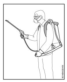
Опрыскиватель нужно носить на двух подвесных ремнях на спине – не носить на одном плече.
