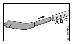
Вставить рукоятку в рычаг – отрегулировать нужную длину (A, B, C)
