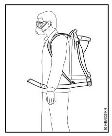
Подвесные ремни отрегулировать таким образом, чтобы наспинная пластина плотно и надёжно прилегала на спине
