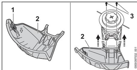
Отрезной нож (1) уже установлен в защиту (2), и его нельзя демонтировать.
